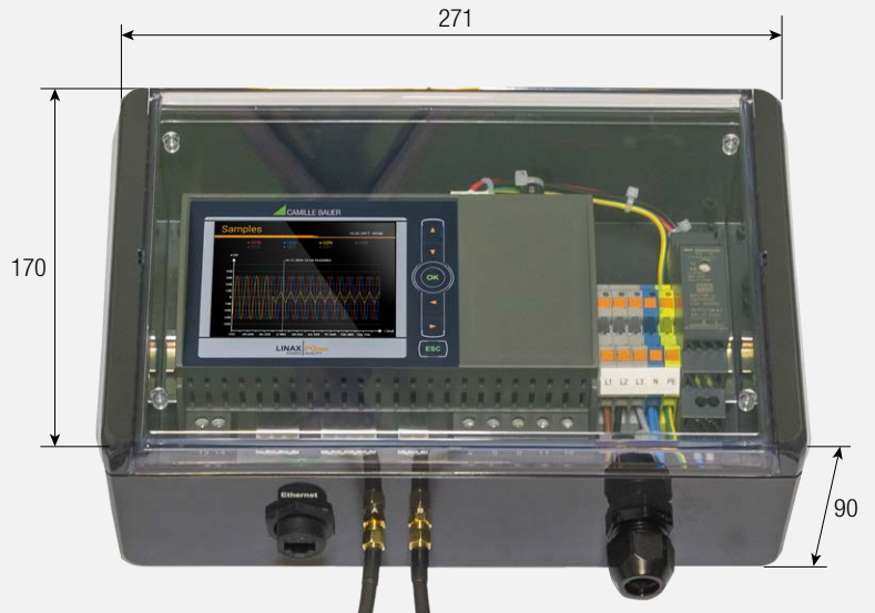
PQ5000CL im Feldgehäuse mit TFT-Display
