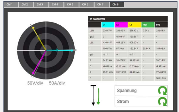
Vektordiagramm zur Anschlusskontrolle
