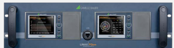
Gerätedesign für zwei Messpunkte
